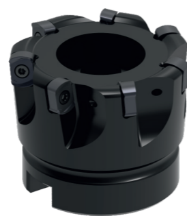
D: 40–63 мм Торцово-насадная фреза
